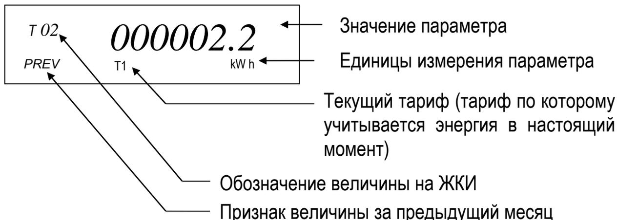
Рис. 2.3 Расположение информации на индикаторе
